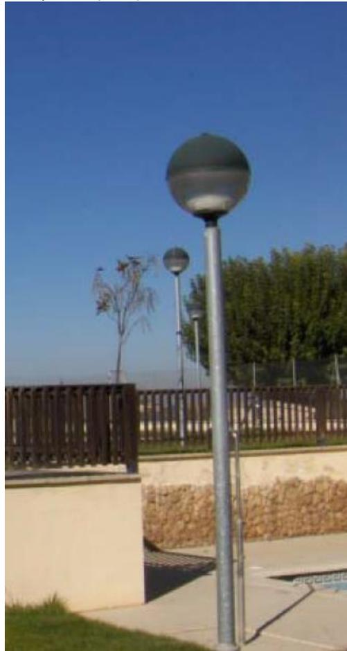
**Fotografía 9** Delante de la puerta de entrada al campo de futbol y las piscinas hay dos halogenuros metálicos de 100 W.
